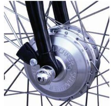
Der Motor ist mit 2 Muttern in der Gabel verschraubt und mit 2 Drehmomentabstützungen gesichert. Wenn Sie den Motor einmal aus der Gabel entnehmen sollten, um z.B. den Mantel oder den Schlauch zu tauschen, achten Sie darauf, diesen wieder korrekt einzubauen und die Kabel nicht zu beschädigen.
