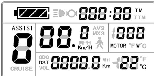
Am Startbildschirm werden folgende Funktionen angezeigt: Batteriezustand, aktuelle Uhrzeit, Unterstützungsstufe, Fahrtgeschwindigkeit, gefahrene Kilometer, Motorleistung, Temperatur, Hintergrundbeleuchtung, Temperatur. Wenn Sie in diesem Menü, einmal den Knopf
