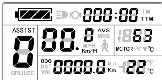
Angezeigt wird die gesamt gefahrene Zeit, gesamt gefahrene Kilometer, Durchschnittsgeschwindigkeit, Motortemperatur.
