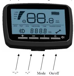
(b) Drücken Sie diesen Knopf, um das LCD-Display einzuschalten. Halten Sie den Knopf für 2 Sekunden gedrückt, um das Display wieder auszuschalten. Wenn keine Funktion verwendet wird, schaltet sich das Display nach 5 Minuten automatisch ab. Es gibt 5 Unterstützungsstufen ("OFF", "ECO", "TOUR", "SPEED", "TURBO"). Drücken Sie + oder \_ um die Stärke anzupassen. Standardwert ist ECO.
