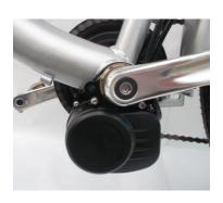
Die Nenndrehzahl liegt bei 90 Umdrehungen pro Minute, die abgegebene Nenndauerleistung beträgt 250 Watt und die maximale Leistung ca. 400 Watt.
