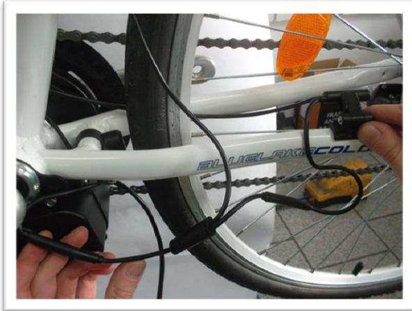
Nun kann der Akku eingeschoben werden und der Bausatz ist vollständig montiert. Die Funktion und Bedienung des Antriebes entnehmen Sie bitte der beigelegten Bedienungsanleitung!
