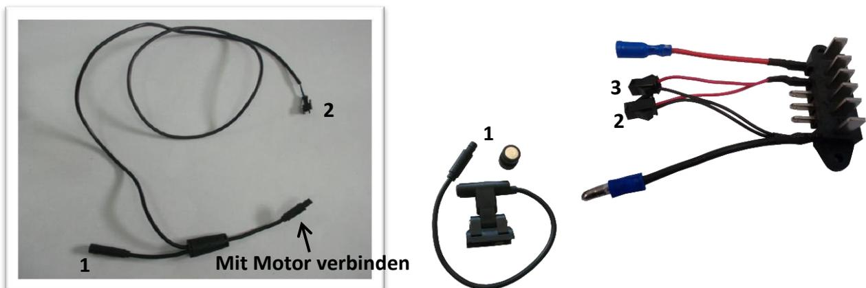
Auf das Kabel vom Vorderlicht muss der Anschlussstecker montiert werden, dieses Kabel kann auf Anschluss 3 angesteckt werden.
