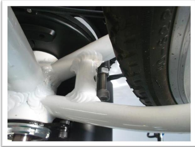
Die Schelle kann zum Schutz des Rahmens mit einem Schrumpfschlauch überzogen werden.
