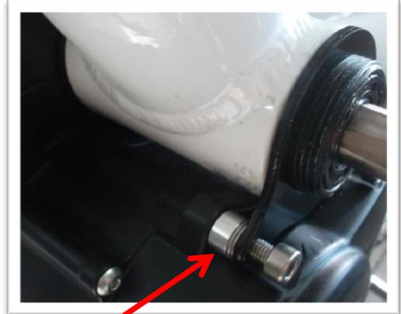
Je nach Rahmenform wählen Sie die passende Montagevariante zur Abstützung des Drehmoments. Variante 1 ist im Lieferumfang inkludiert!
