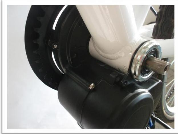
Kontrollieren Sie ob der Motor auf der rechten Seite (Kettenseite) komplett am Tretlagerrohr anliegt. Sollte das nicht der Fall sein, muss der Abstand mit Distanzscheiben ausgeglichen werden! Achten Sie auch darauf, dass das Getriebegehäuse nicht am Rahmen anliegt.
