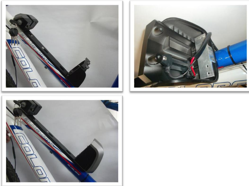
Verschrauben Sie den Deckel mit den 4 Blechschrauben
