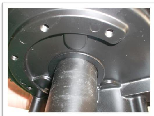
Nach dem Ausgleich der Kettenseite muss der Abstand zwischen Motor und Sicherungsplatte mit den Distanzscheiben ausgeglichen werden. Ziehen Sie die zwei M5-Schrauben nur leicht an.
